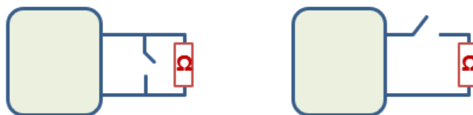
Figura 10. Izda.: normalmente abierto (paralelo). Dcha.: normalmente cerrado (serie).
